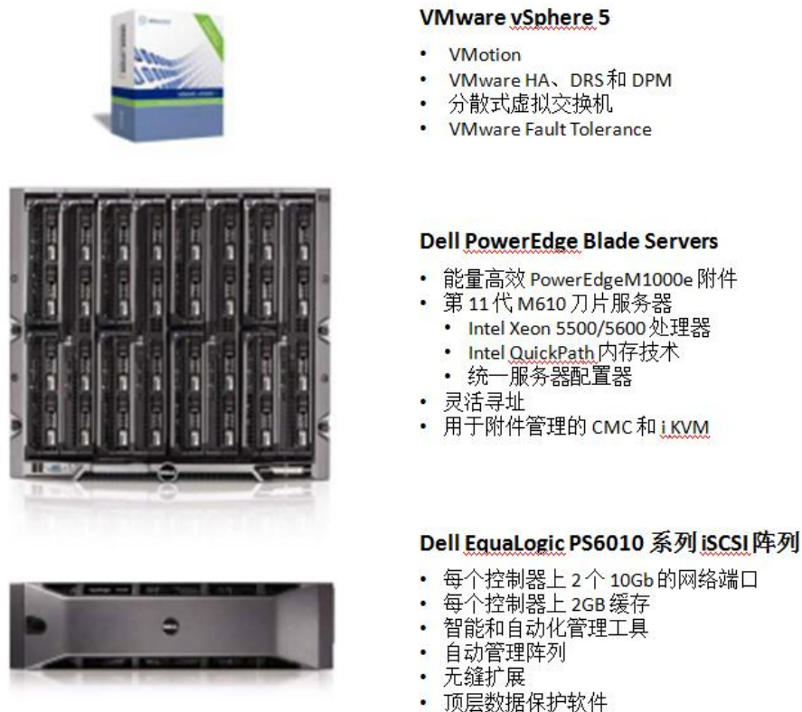
图5. Dell刀片服务器和VMware 虚拟化方案
