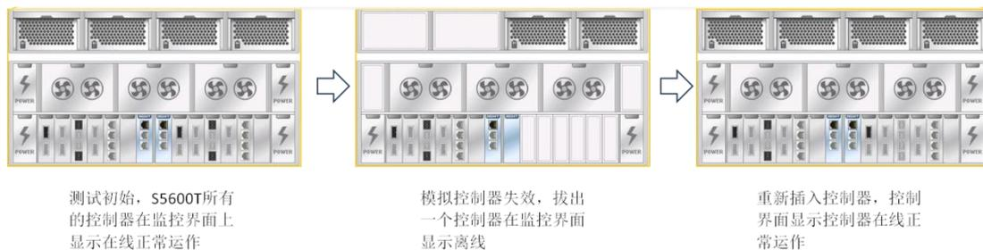
图18（从左到右依次对应：系统原始状态、故障状态和恢复正常状态）的测试结果显示，在控制器拔插的过程中，IOmeter一直保持运行，在控制器切换时业务没有受到影响。
