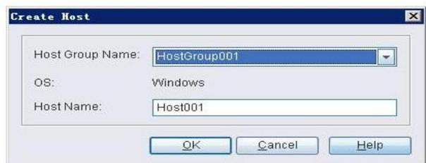
**配置Initiator：** 配置流程是将新卷映射到服务器。如图8所示，中桥实验室点击“Configure Initiator”按钮进入配置初始化对话框，将主机映射到Windows服务器的FC Initiator地址上。
