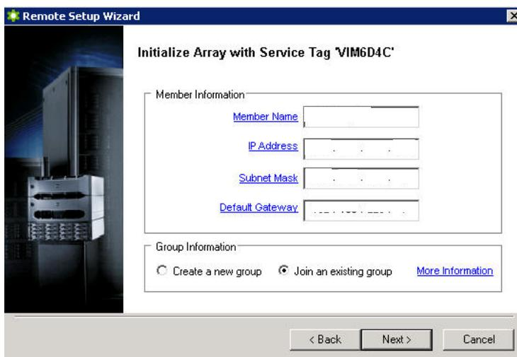
下一步，将新阵列加入已有存储组，如图18所示，先选择将要加入的存储组名（demogrp）和IP地址，以及网络连接方式（DCB或VLAN）。只通过这两个管理界面，在1-2分钟内即可完成扩容。
